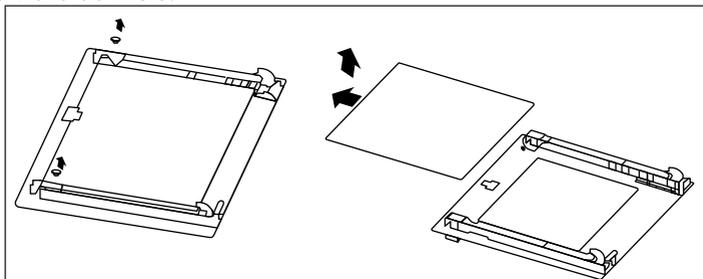
Limpe os vidros e outras peças com um pano úmido ou uma esponja limpa e uma solução de água quente com um pouco de detergente. Seque utilizando um pano macio. Para a montagem da porta, siga as instruções novamente, mas na ordem reversa.
