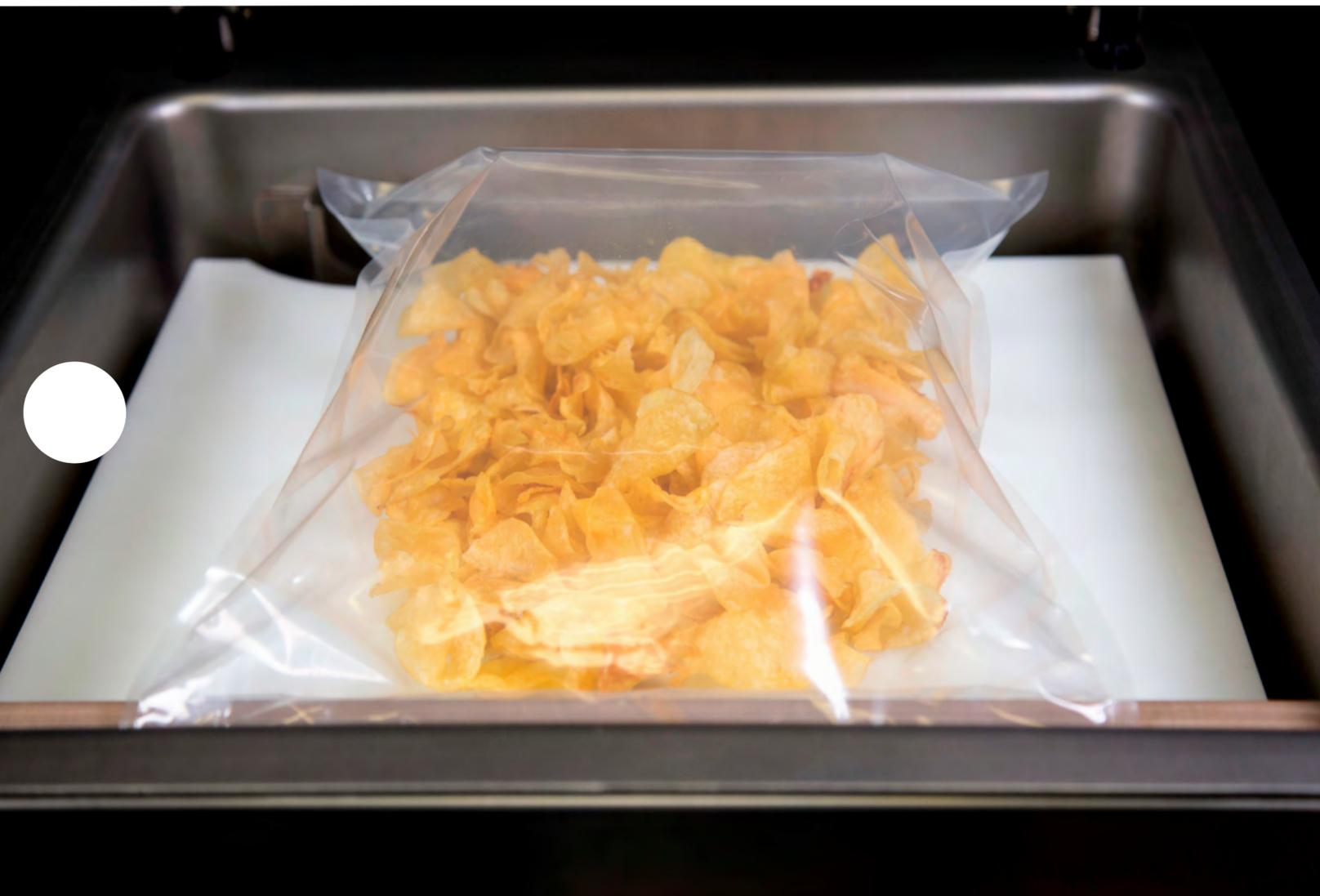
La instalación del sistema de inyección de gas inerte es opcional en todos los modelos. Esta función permite envasar con atmósfera protectora. Según el gas empleado y el producto a envasar, se obtiene una mejora en la conservación del producto, en su aspecto o se evitan daños en el caso de productos frágiles.
