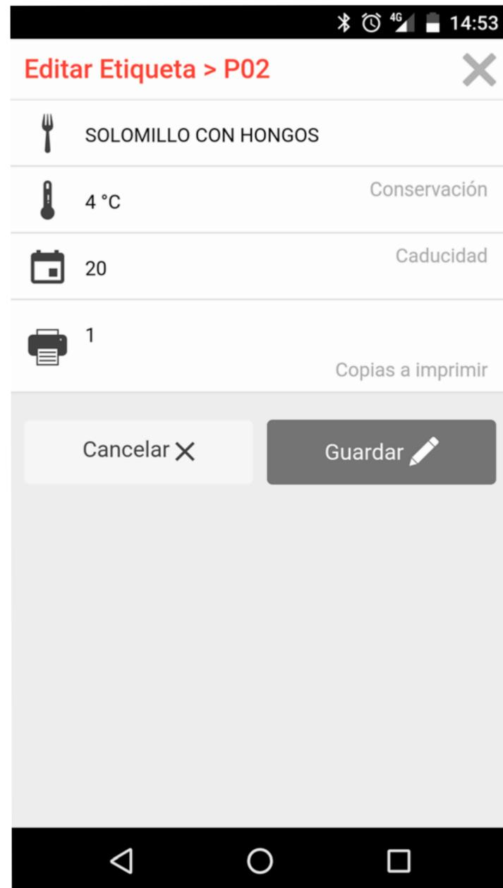
La introducción de textos para el etiquetado se realiza mediante la app SammicVAC y se transmite a la envasadora. En la misma, se introduce el nombre de la receta, los días de caducidad, la temperatura de almacenamiento y los valores del programa de envasado. Las etiquetas se imprimen, de forma automática y en la cantidad solicitada, al final del ciclo.
