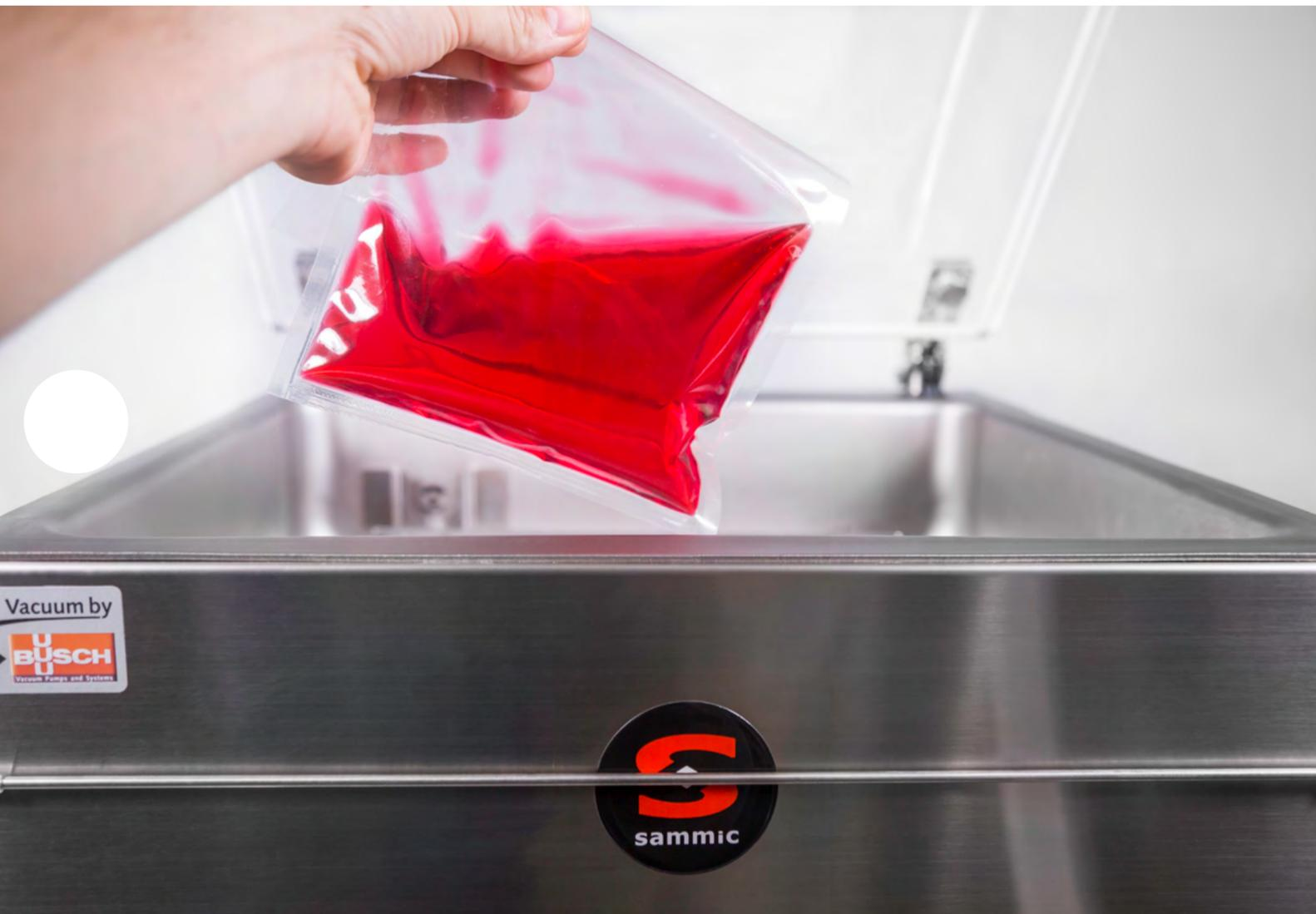
Gracias al nuevo sistema para la detección del punto de evaporación de salsas, sopas, frutas, carne roja, etc., se detiene automáticamente el proceso de vacío, evitando el desbordamiento de líquidos en la cámara y garantizando el máximo vacío posible para cada producto. Así, se previene el resecamiento del producto y la contaminación del aceite de la bomba. El tiempo de vacío es siempre el óptimo para el producto a envasar.
