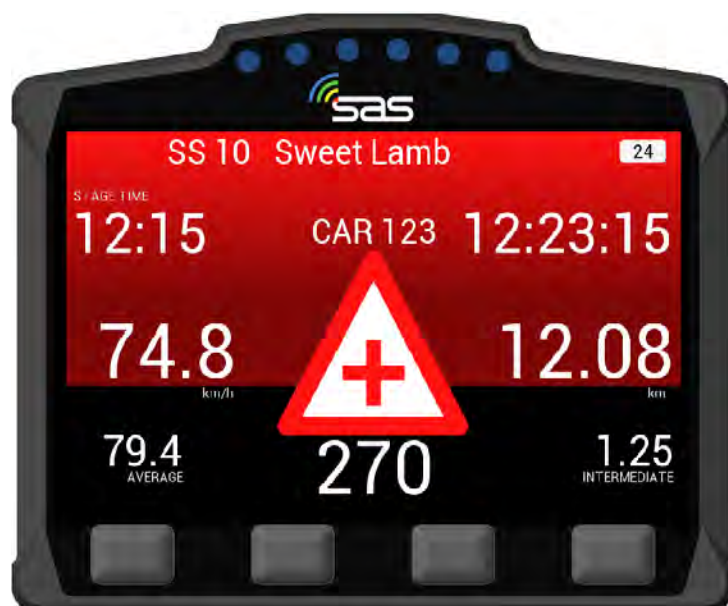
BILD 23: Warnung - Fahrzeug steht auf oder neben der Strecke, Status SOS - Alarm ausgelöst
