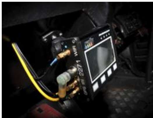
Bild 3: Standardinstallation Gerät+Antenne in klarer / ungehinderter Sicht
