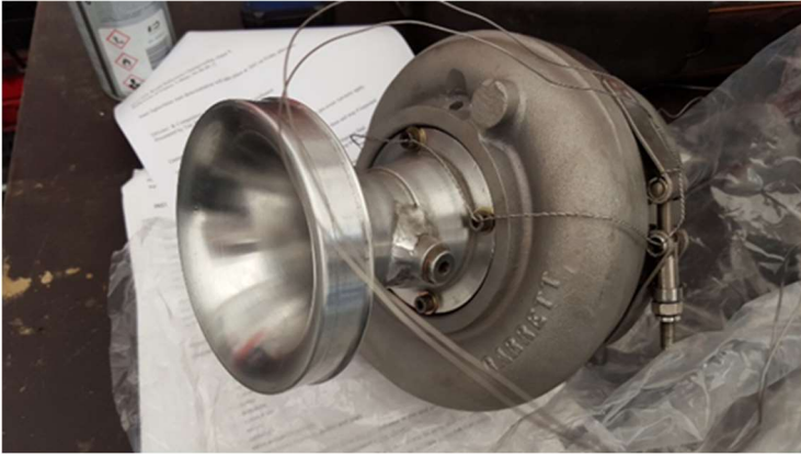
Esimerkkejä virheellisestä turbon sinetöinnin langoituksesta:
