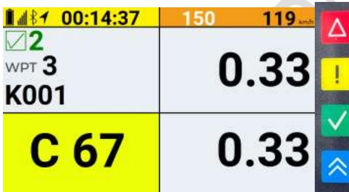
Foto 23. Display DETECCIÓN ZONA NEUTRALIZADA Y REDUCCIÓN VELOCIDAD.
