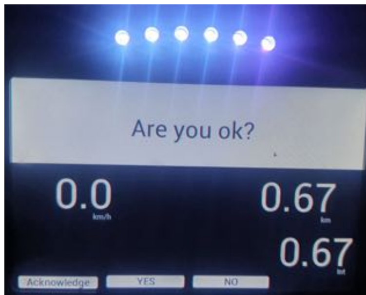
BILD 31: Bsp. einer individuellen / manuellen Mitteilung Frage: Sind sie OK? – Antwort noch ausstehend
