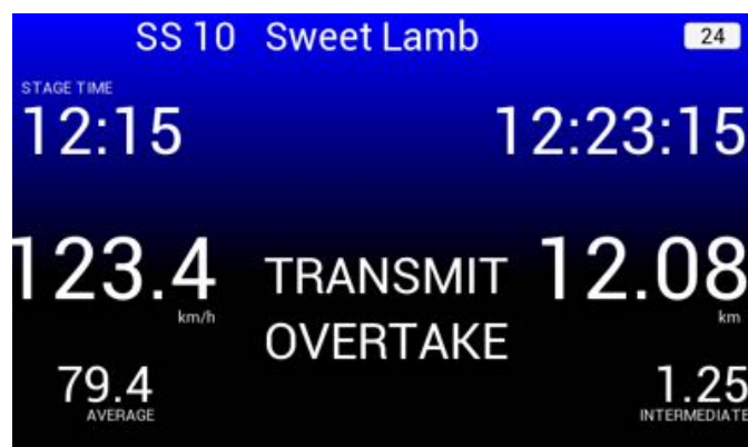
BILD 25: Übertragung Überholanfrage an auflaufendes Fahrzeug - „Transmit Overtake“
