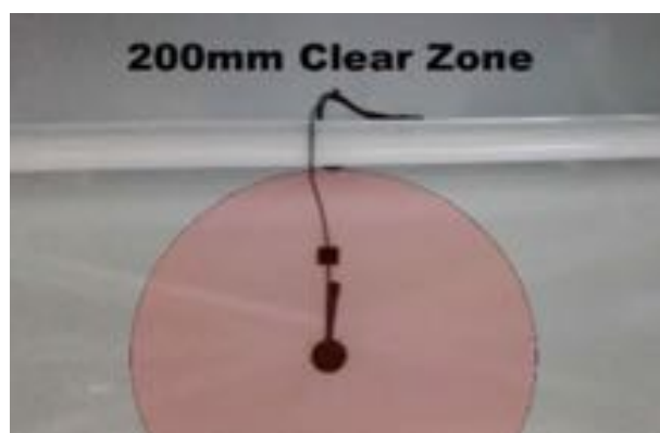
Bild 15: „freie Zone“ – Abstand von mind. 200 mm zu allen Komponenten des Überrollkäfigs
