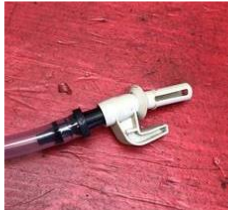
AANGEPASTE BAK ONTLUCHTER VOOR AANSLUITING SLANG. (MAG OOK VIA BUSJE IN BAK)
