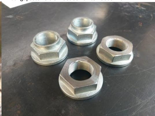
Stap 2: de originele (onaangepaste) moer terug monteren en vastdraaien op 180Nm.
