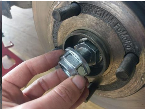
Stap 2: de originele (onaangepaste) moer terug monteren en vastdraaien op 180Nm.
