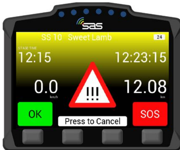
BILD 5: Manueller Alarm (Hazard)
