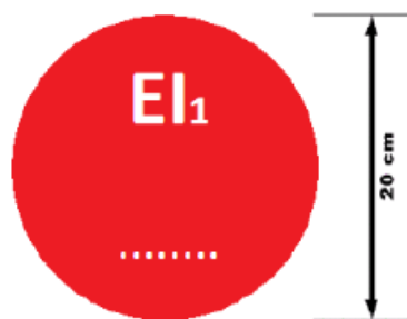
Figuur 3: Label branddeur/-poort: aanduiding brandweerstand.
