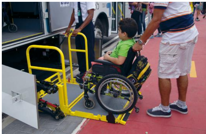
► Criança com deficiência utilizando plataforma mecânica de acesso a ônibus na cidade do Rio de Janeiro, em 2016.
