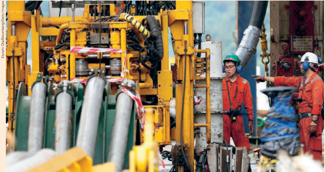
Trabalhadores a bordo do navio de pesquisa Chikyu, que conduz perfuradora capaz de atingir 7 mil metros abaixo do fundo oceânico. Japão, 2013.
