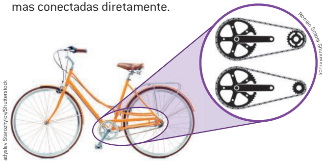
A bicicleta apresenta rodas dentadas (veja no detalhe) que estão conectadas por uma corrente.
