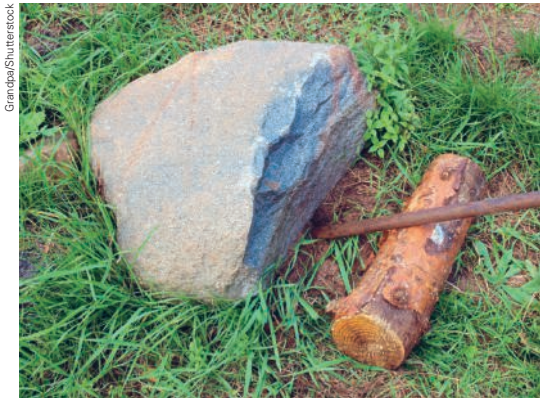
Alavanca feita com um pedaço comprido de ferro e um ponto de apoio de madeira, usada para mover uma pedra pesada.
