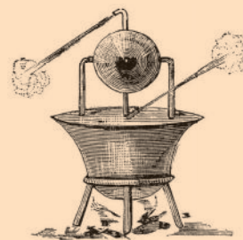
A eolípila foi a primeira máquina térmica, inventada por Heron de Alexandria, no século I.
