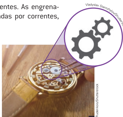
As engrenagens (veja no detalhe) conectam-se diretamente e estão presentes nos relógios, por exemplo.
