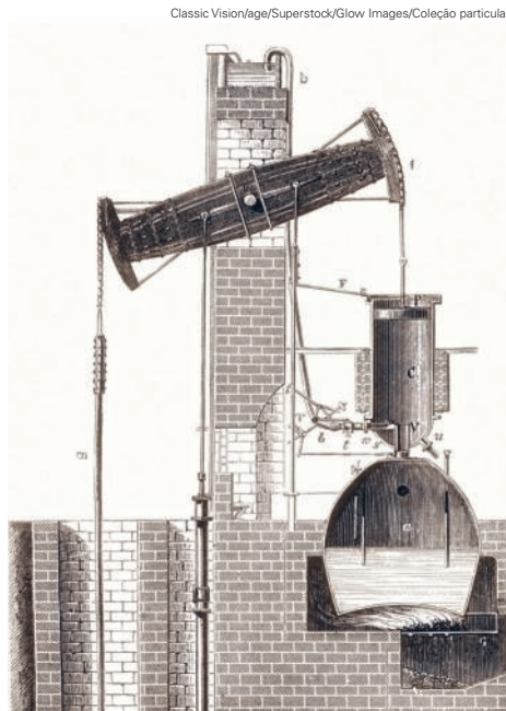
A máquina a vapor de Newcomen foi criada para retirar água das minas.
