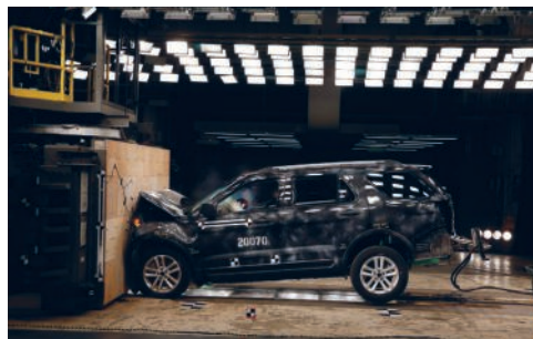
Por meio do crash test (teste de impacto aplicado em automóveis), as montadoras avaliam, durante o choque, o quanto e como as forças interferem na deformação do automóvel.
