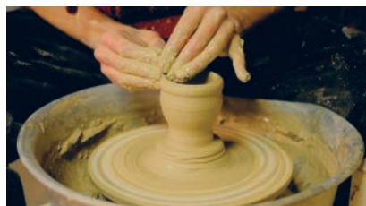
A roda de oleiro é um equipamento construído a partir de uma roda que gira constantemente e é utilizada na produção de utensílios feitos à base de argila.
