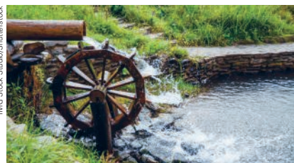
O moinho de água, também chamado de azenha, é um mecanismo elaborado com uma roda movida a partir da energia cinética da água. É utilizado na moagem de grãos, na irrigação e na geração de energia elétrica.
