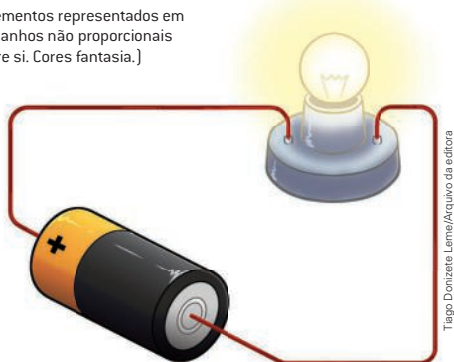
Lâmpada de baixa resistência elétrica ligada a uma bateria. A corrente elétrica será bem intensa.
