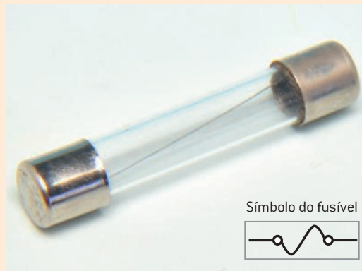
O fusível e seu símbolo, usado em representações de circuitos.
