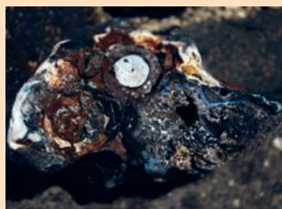
Imagem de um plastiglomerado encontrado no Havaí. Plastiglomerados são rochas formadas por sedimentos de origem mineral e materiais plásticos.
