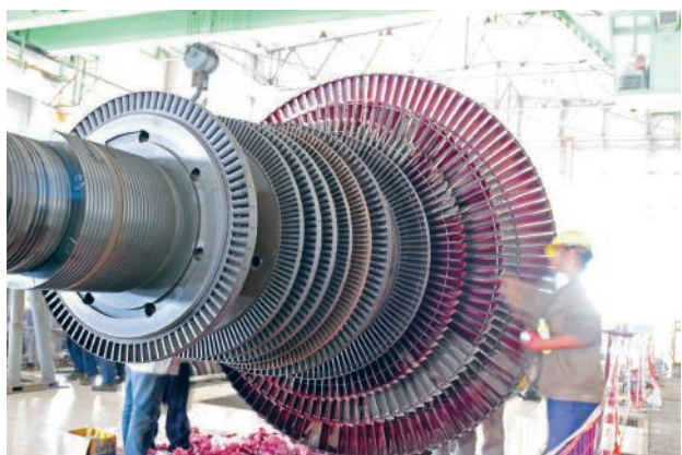
Fotografia de uma turbina elétrica que funciona pela pressão do vapor de água.
