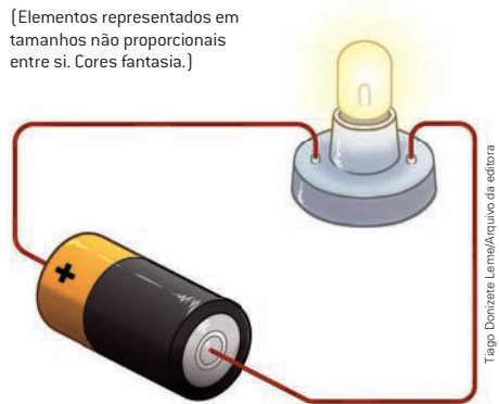
A corrente elétrica é pouco intensa, pois a lâmpada apresenta uma resistência elevada.
