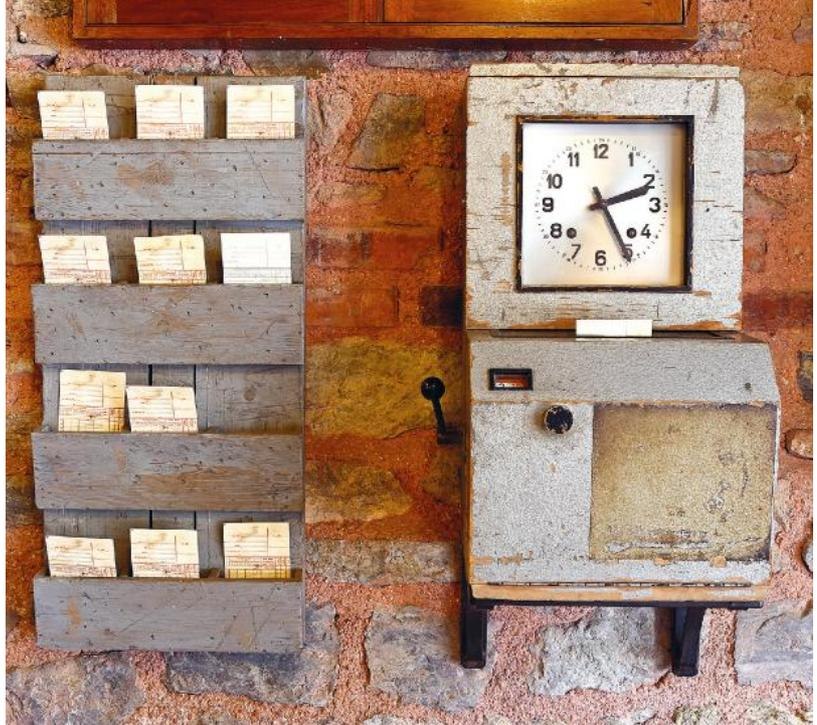
Antigo relógio de ponto. As fichas à esquerda deveriam ser carimbadas pela máquina, indicando a hora de entrada e de saída de cada trabalhador.
