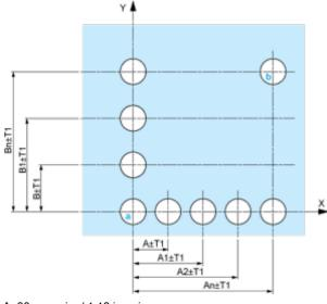
A: 30 mm min. / 1.18 in. min. B: 40 mm min. / 1.57 in. min.
