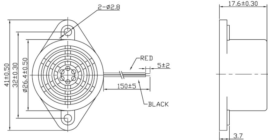
**Dimensions** Unit: mm Tolerance:  $\pm 0.5\text{mm}$
