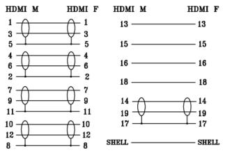
1. HDMI CABLE V1.4 WIRE GAUGE: 30AWG COPPER [(30#\*1P+D+FAM)\*5P +30#\*4C+AL+D+BLACK PVC6.0MM]
