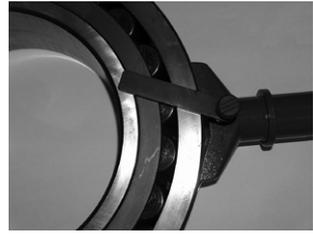
Die beiden Innenringhalter müssen auf der gleichen Seite des Lagers platziert werden. Es ist darauf zu achten, dass die Innenringhalter nicht in die Bohrung des Innenrings, gegen den Käfig oder gegen die Wälzkörper platziert werden. Durch eine falsche Platzierung der Innenringhalter kann das Lager beschädigt oder seine Montage auf der Welle erschwert werden.
