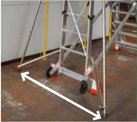
Stabilizzatori aperti. Open stabilisers.
