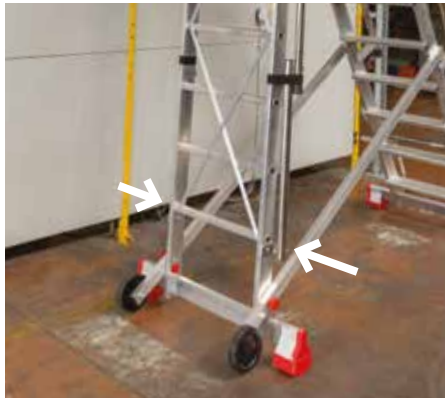
Stabilizzatori chiusi. Closed stabilisers.
