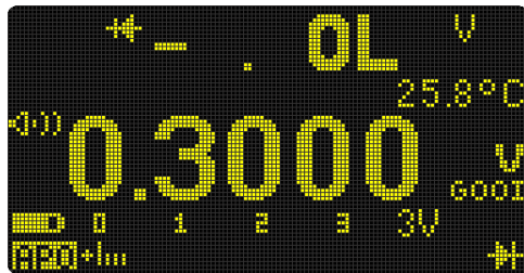
Figure 2-24 Affichage de la fonction de diode automatique (état GOOD)
