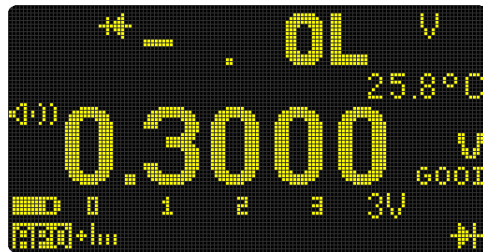
Figura 2-24 Visualizzazione dell'autodiado (GOOD, stato funzionante)
