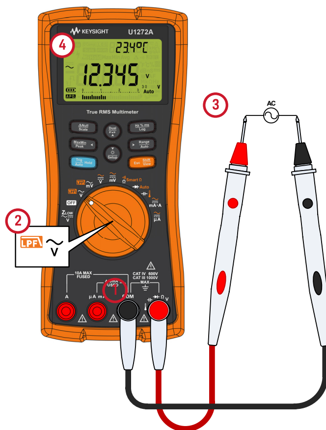
Figura 2-2 Medición de tensión de CA
