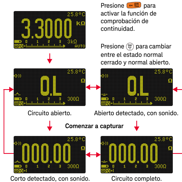
Figura 2-15 Operación de continuidad
