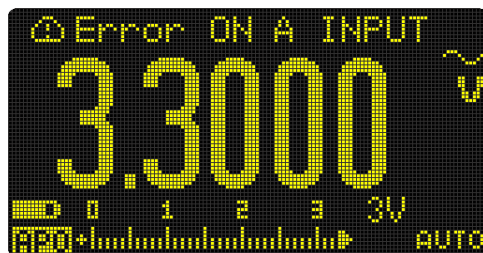
Figura 1-3 Avvertenza terminale di ingresso (A INPUT)
