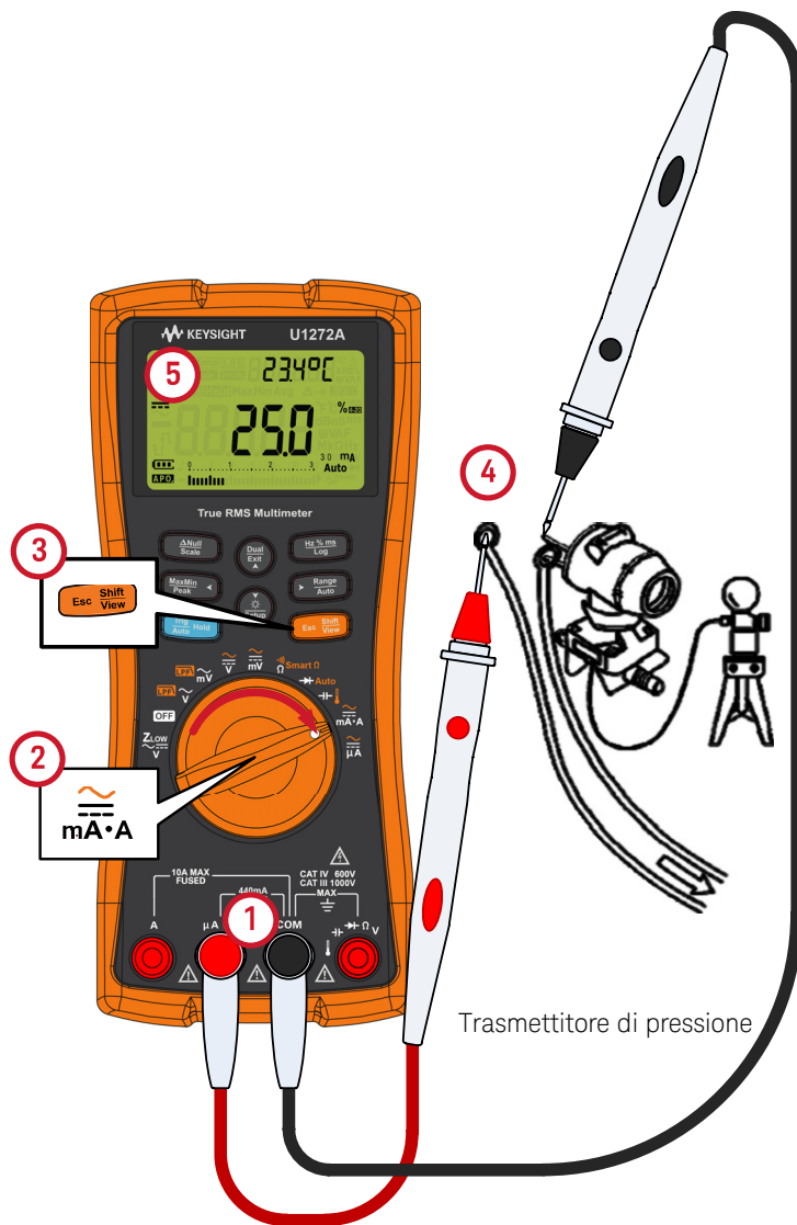
Figura 2-36 Misurazione della corrente CC utilizzando la scala % di 0-20 mA
