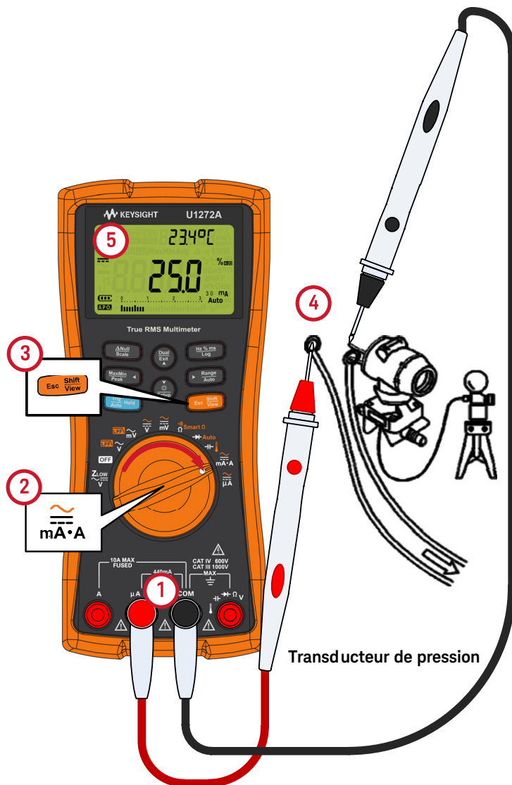
Figure 2-36 Mesure d'un courant CC à l'aide de l'échelle de pourcentage 0-20 mA
