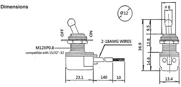
UNIT:mm & inch +-0.3mm tolerance
