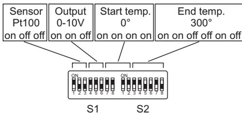
Alle DIP-Schalter Off: Parametrierung über FDT/DTM
