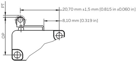
**FIGURE 16. V19 SERIES A06/ROLLER LEVER**
