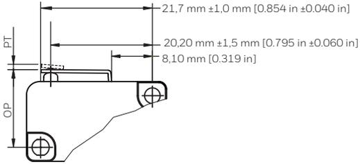
**FIGURE 12. V19 SERIES A02/STANDARD STRAIGHT LEVER**
