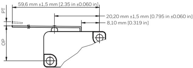
**FIGURE 14. V19 SERIES A04/SIMULATED ROLLER LEVER**
