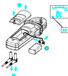
**⚠ Avertissement :** déconnectez le multimètre de toutes les sources d'alimentation et éloignez-le d'un conducteur, le cas échéant, avant de retirer le couvercle du compartiment à pile.
