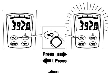
Die Anzeigenhinterleuchtung schaltet nach ca. 60 Sekunden automatisch ab.
