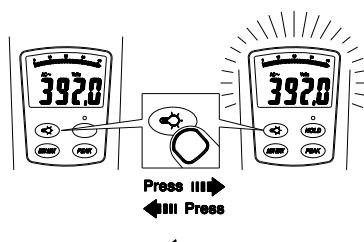
*La luz posterior se apagará automáticamente al cabo de unos 60 segundos.*
