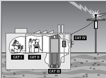
Um Ihr Instrument und – noch wichtiger – auch sich selbst zu schützen, sollten Sie ein Meßgerät wählen, das den elektrischen Gefahren der Umgebung, in der Sie das Gerät einsetzen möchten, gewachsen ist. Die Norm EN61010 gibt internationale Sicherheitsanforderungen für elektrische Meßgeräte vor. In dieser Norm wird zwischen verschiedenen elektrischen Umgebungen unterschieden, die nach der Gefahr von Hochspannungs-Energiestransienten in
