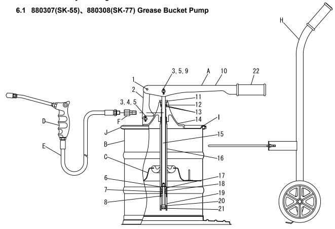
GREASE BUCKET PUMP PARTS LIST
