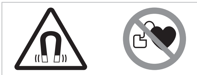
Abb. 12: Warn- und Verbotsschilder auf einem Verdichter mit LSPM-Motor
