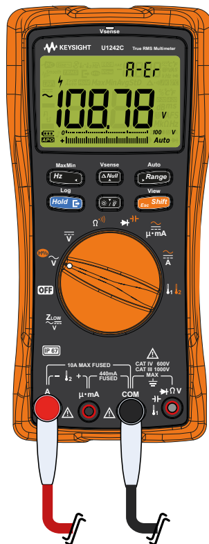
Figure 1-2 Exemple de mauvaise entrée du terminal
