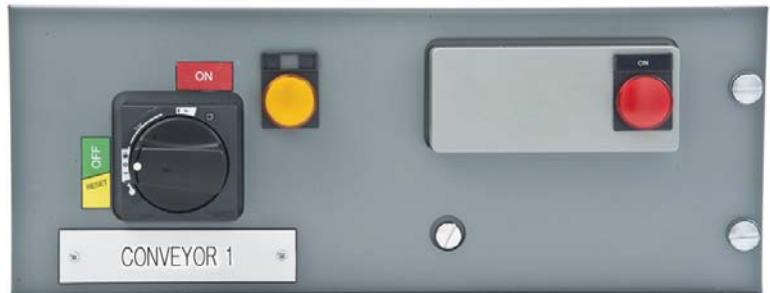
Figure 12 : Manette de fonctionnement sur la position d'arrêt (O/OFF)
