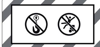
► Ne pas accrocher l'aspirateur sur un crochet de grue, par ex. pour le transporter. L'aspirateur ne peut pas être manipulé par une grue. Danger de blessures et de dommages.
