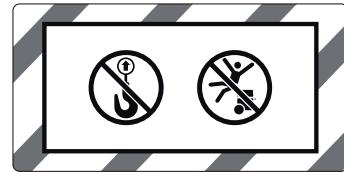
▶ **運送時，請勿將吸塵器掛在起重機的掛鉤上。** 吸塵器不可用起重機吊運。可能會造成人員受傷或物品損壞。
