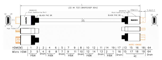
兄 AWM 20276 80℃ 30V VW-1 HIGH SPEED HDMI® CABLE WITH ETHERNET
