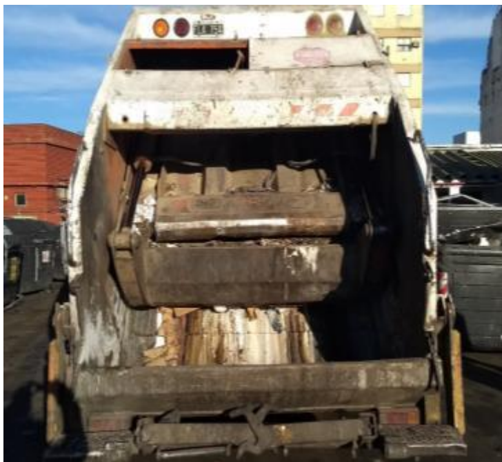
Caja oxidada, suciedad, sin bandas reflectarias, luces y asidero.
