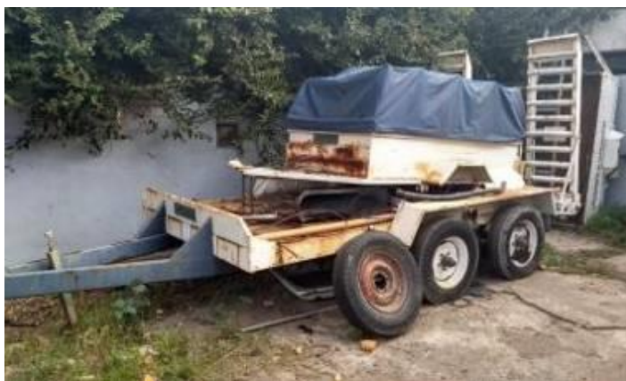
Sin rueda sin logo del EHU, oxido falta de mantenimiento,
