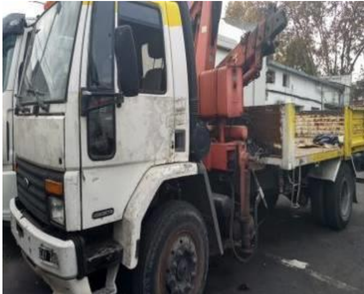
Falta de ploteo, caja sin puerta y falta de pintura.
