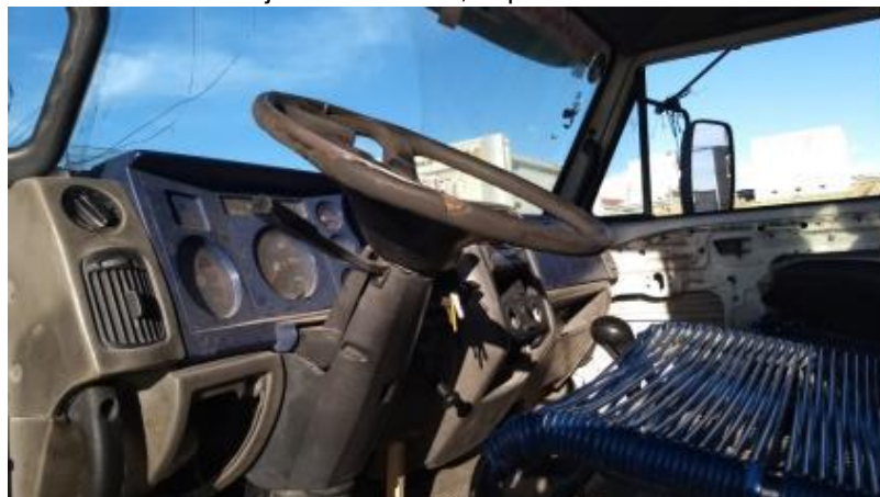
Interior de un camión volante sin recubrimiento, falta de paneles y parabrisas astillado
