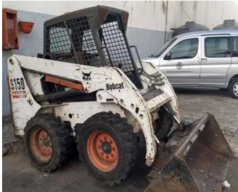
Sin matrícula, sin luces, sin logo del EHU, falta de mantenimiento
