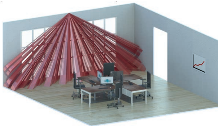
La modalità di funzionamento dei sensori di movimento PaPIRs sviluppati da Panasonic Industry
