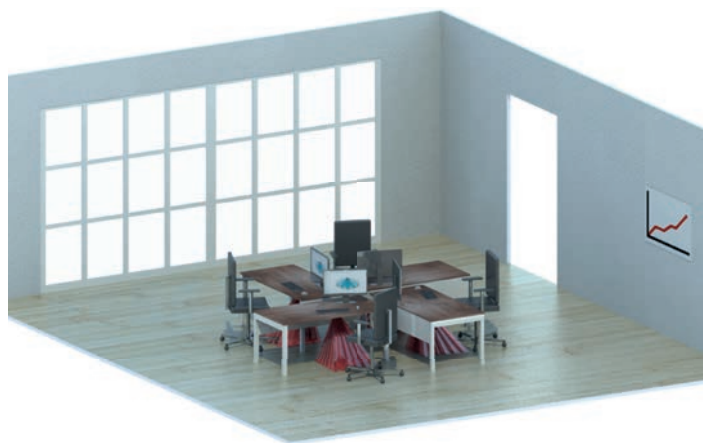
La modalità di funzionamento dei sensori di movimento PaPIRs sviluppati da Panasonic Industry
