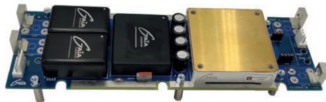
Una scheda di alimentazione da 500W
