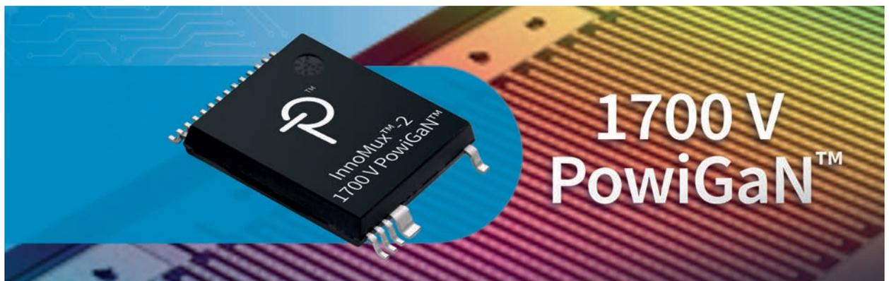
L'**InnoMux-2** è un circuito integrato per alimentatore flyback, con tensione nominale di 1.700V
