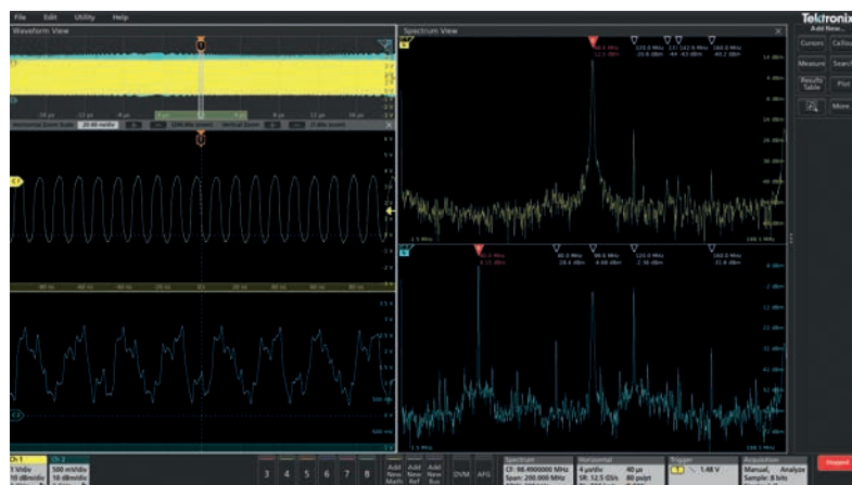
Esempio di visualizzazione combinata tempo-frequenza su due canali indipendenti con SpectrumView
