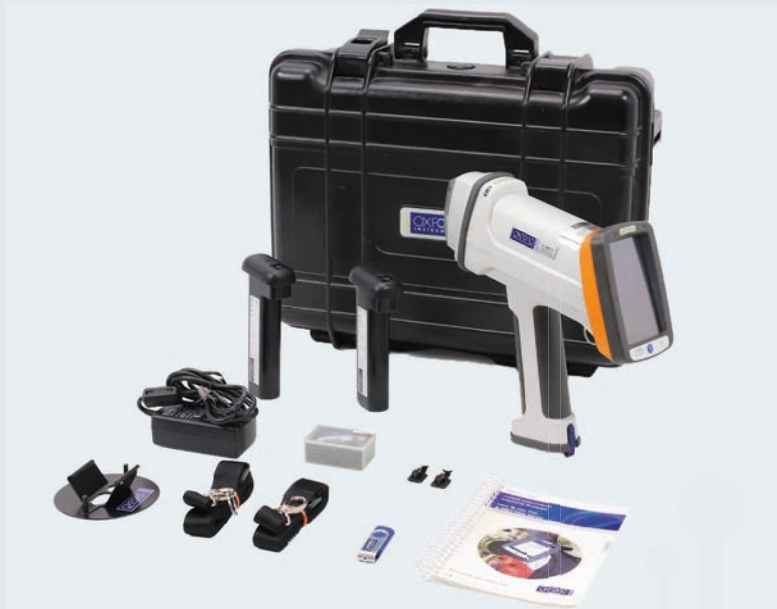
Figura 1: L'analizzatore Oxford Hitachi XRF X-MET 7000 utilizzabile per identificare attraverso l'analisi dei pin i componenti rilavorati o venduti in violazione delle normative RoHS.
