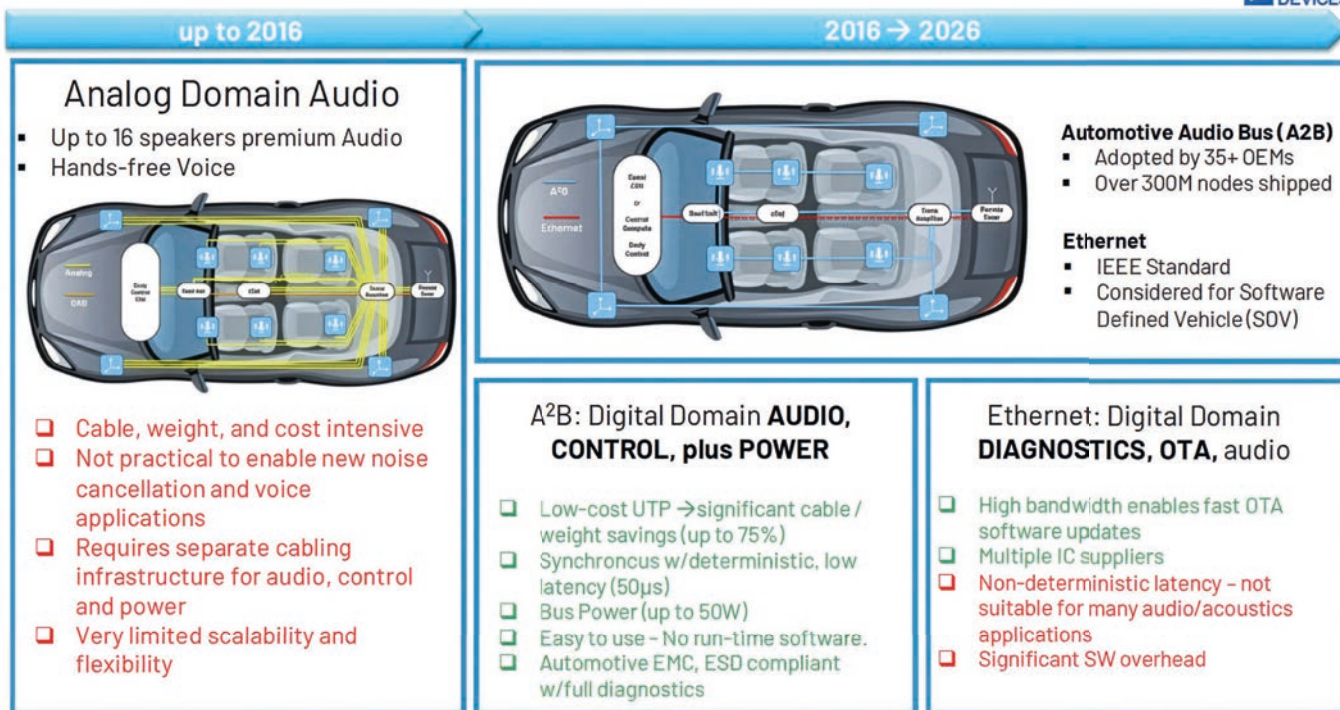
Figura 1: L'evoluzione delle connessioni audio di bordo, dall'era analogica a quella digitale. A confronto le funzionalità rese disponibili tramite doppino differenziale dall'Automotive Audio Bus (A2B) nel collegamento dei vari nodi all'interno del veicolo.
