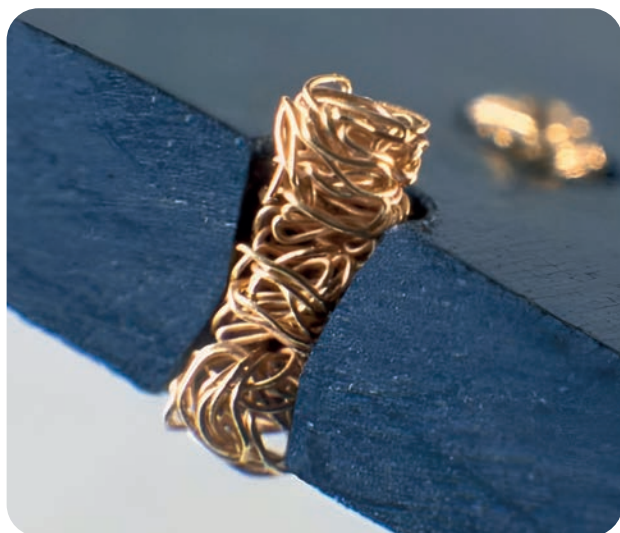
La configurazione microscopica dei pin CIN::APSE è ottimizzata per offrire elasticità meccanica, oltre a minima induttanza e bassa resistenza di contatto.
