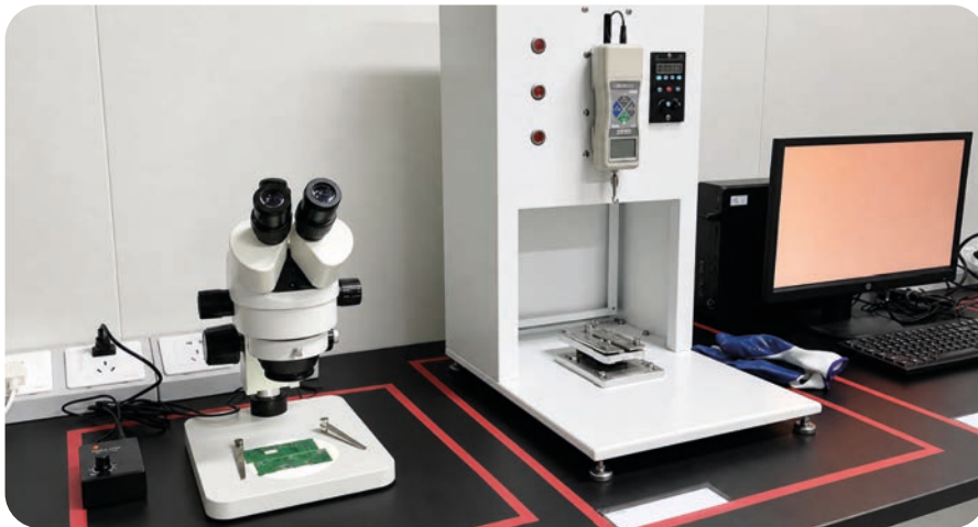
Figura 3: Dopo la fase di laminazione sono importanti gli esami delle microsezioni per conoscere l'esatto spessore degli strati isolanti interni, la resistenza agli shock termici e alla trazione applicata alla lamina di rame (peel test).
