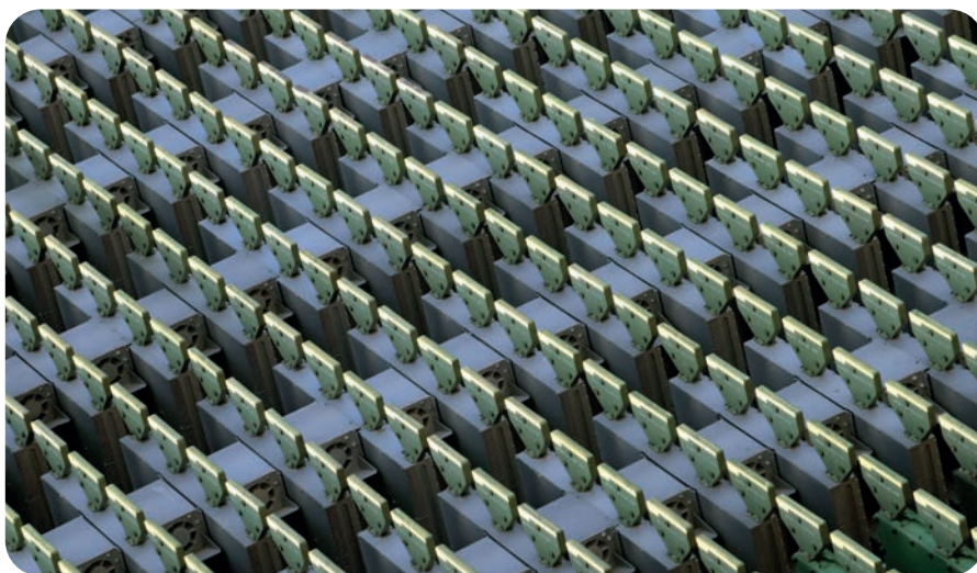
Figura 1: Electronically Scanned/Steerable Array (ESA) è una tipologia di antenne multi elemento che permette di ottenere i fasci d'irradiazione desiderati senza spostamenti fisici.
