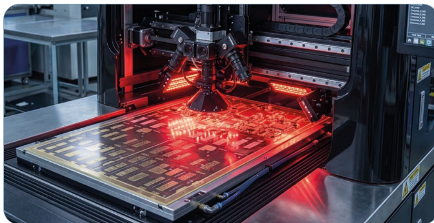
Figura 4: L'AOI (automated optical inspection) è realizzata dopo la placcatura. La camera scorre come uno scanner sopra il circuito rilevando i minimi difetti nella produzione.
