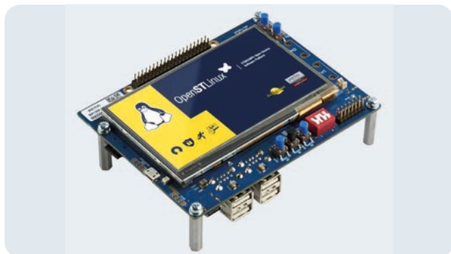
Figura 1: La scheda STM32MP135F dotata di SoC Arm Cortex-A7 e supporto OpenSTLinux costituisce una valida opzione per le semplici applicazioni Linux embedded.
