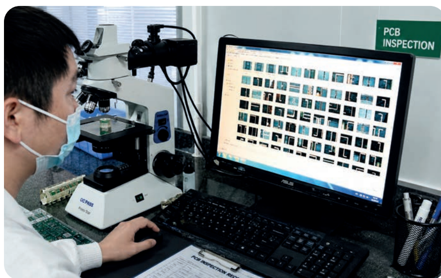
Figura1: I test su PCB riguardano la qualità dei materiali e dei processi di produzione. Si fanno in genere con la metallografia microscopica, l'ispezione a raggi X dei layer interni, il controllo delle placcature, di impedenza, resistenza, bagnabilità dei pad per la saldatura.
