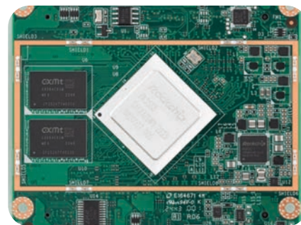
Figura 6: I nuovi SOM basati su processori Rockchip e conformi allo standard RTXe assicurano prestazioni affidabili in un gran numero di applicazioni industriali.
