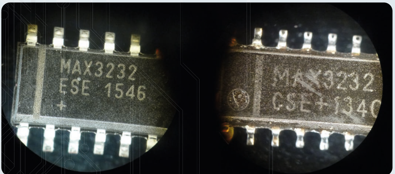
Figura 1: Un chip originale può essere riconosciuto dalle marcature laser di buona qualità rispetto al clone realizzato con un differente sistema di stampa
