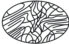
Yarı Kristal Yapı Semi Crystalline Structure
