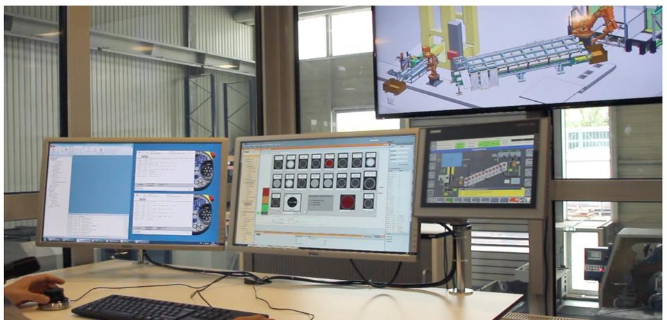
Im Raum des „Digitalen Zwillings“: Zwei Robotersteuerungen (ABB RobotStudio) und eine SPS (S7-1500) werden mit Simit, den Schnittstellen von iSILOG und NX MCD in Betrieb genommen.
