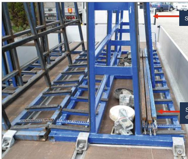
Sicherungs-Spannlatte unter Zug
