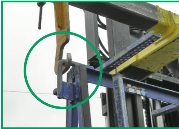
Stellen Sie sicher, dass die Glasgestelle nur an den Kranösen hochgehoben werden!
