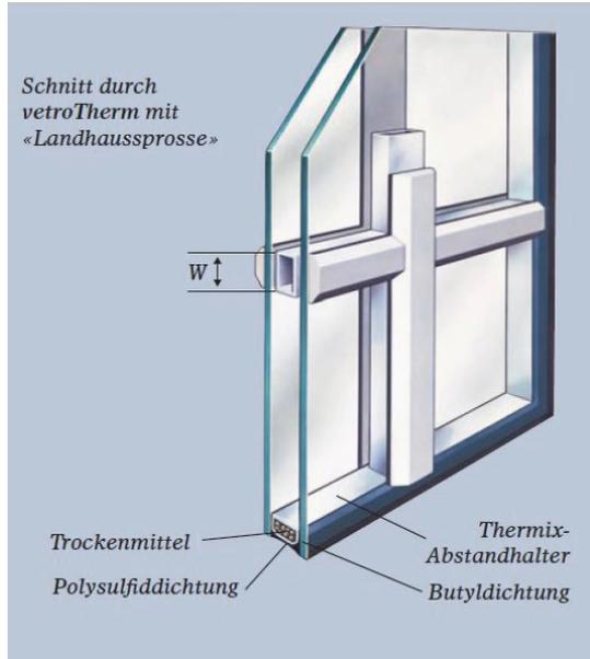
Standard W-Masse: 21.5, 25.5, 31.5 mit Kastenprofil
