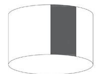
Zylindrische Biegung Die herzustellenden Maximalmasse werden in Absprache festgelegt. Sie sind abhängig vom jeweiligen Glastypen und Glasaufbau.
