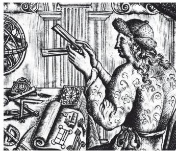
L'usage du compas de proportion à l'aide d'un compas à pointes sèches ; détail d'une gravure sur bois illustrant le traité de Denis Henrion, L'usage du compas de proportion , Paris, 1681.
