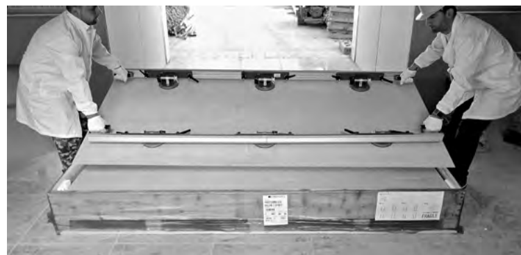
Aluminiumrahmen mit Saugnäpfen, leicht zu transportieren, da zerlegbar
