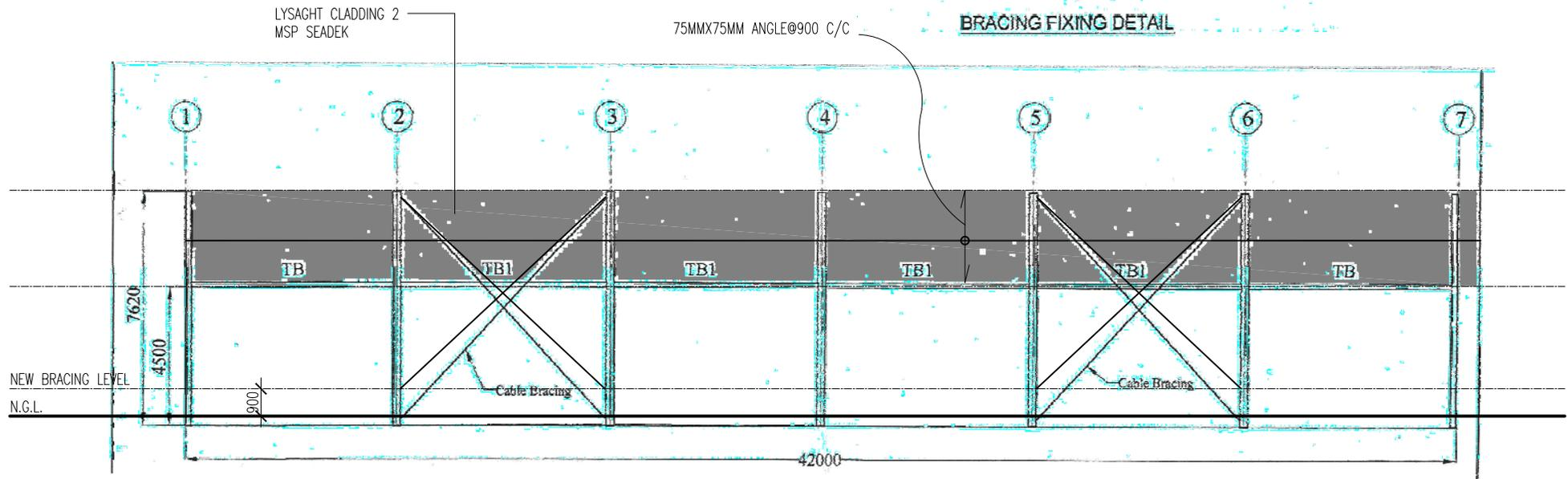
CABLE BRACING ELEVATION
