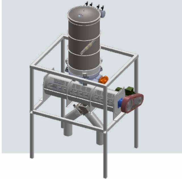
Mescolatori a nastro o a vomeri per assicurare la miscelazione e l'omogeneizzazione di prodotti in polvere o granuli. Sono costituiti da una camera di miscelazione, in cui viene inserito un albero rotore con spire contrapposte o con aspi rotanti. L'imboccatura di carico può essere centrale oppure può coprire l'intera lunghezza della camera; lo scarico è invece consentito da una bocca centrale con valvola di chiusura o da un'apertura totale della camera con bocca di sfiato.
