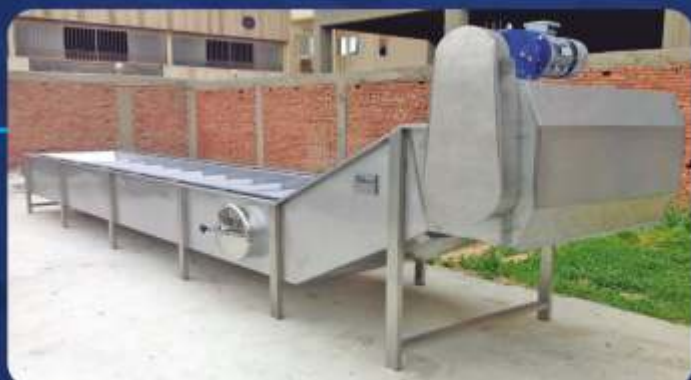
وحدة تبريد بنظام الغمر على حصيرة Belt Cooler by immersion system
